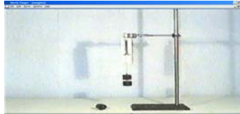
Σχήμα 2: Βίντεο με το πείραμα « ένα αντικείμενο πάνω σε ένα ελατήριο (νόμος του Hooke) »
